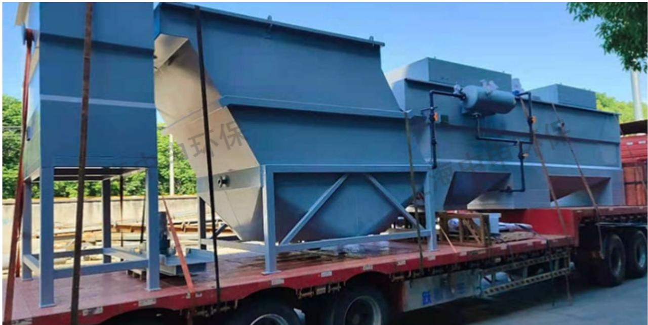
斜板沉淀池，是一种在沉淀池内装置许多间隔较小的平行斜板的沉淀池，具有去除效率高，停留时间短，占地面积小等优点，故常用于已有的污水处理厂挖潜或扩大处理能力时采用；当受到污水处理厂占地面积的限制时，作为初次沉淀池用。斜板沉淀池不宜于作为二次沉淀池，因为活性污泥的粘度较大，容易粘附在斜板上，影响沉淀效果甚至可能堵塞斜板。同时，在厌氧的情况下，经厌氧消化产生的气体上升时会干扰污泥的沉淀，并把板上脱落下来的污泥带至水面结成污泥层。斜板沉淀池因沉淀时间短，故在运转中遇到水量、水质变化时，应加强注意管理。采用此类沉淀池时，还应注意絮凝的完善和排泥布置的合理等。斜板沉淀池批发厂家，欢迎咨询上海中申环境工程有限公司。新型斜板沉淀池治理
